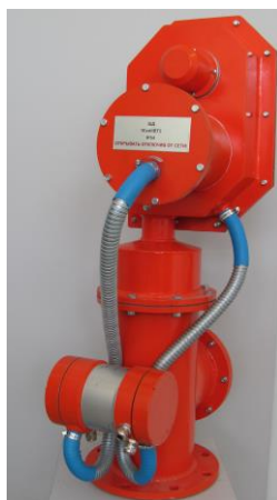
Рисунок 1 – Общий вид устройства измерения систем измерения массы и объема нефтепродуктов в резервуаре СИМОН-2
